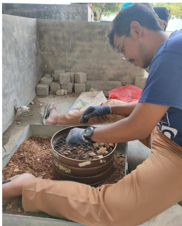
Gambar Lampiran- 26: Pengolahan tempurung kelapa.
