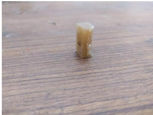
Gambar 4.2 Spesimen 1 Setelah di Uji Tekan
