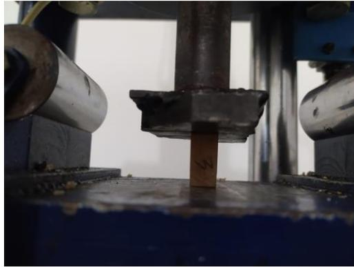
Gambar 4.5 Spesimen 3 Sebelum di Uji Tekan
