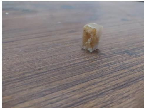
Gambar 4.8 Spesimen 4 Setelah di Uji Tekan
