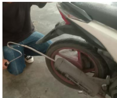
Gambar 3.13 Memasukkan sensor probe.
