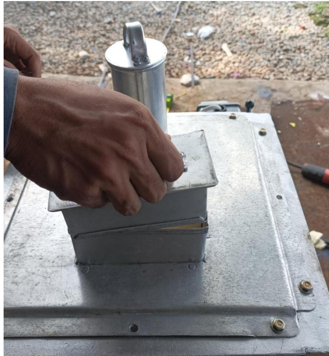
Gambar 4.20. Proses Penekanan Corong Berbentuk Persegi Panjang
