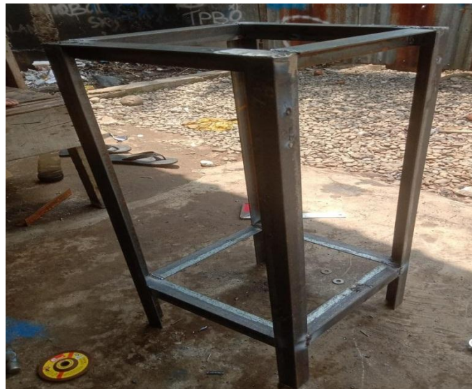
Gambar 4.5. Hasil Awal Pembuatan Rangka
