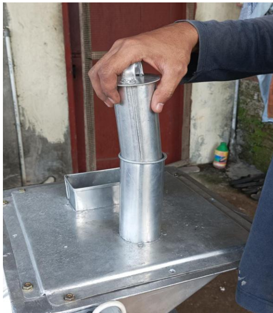
Gambar 4.19. Proses Penekanan Corong Berbentuk Tabung
