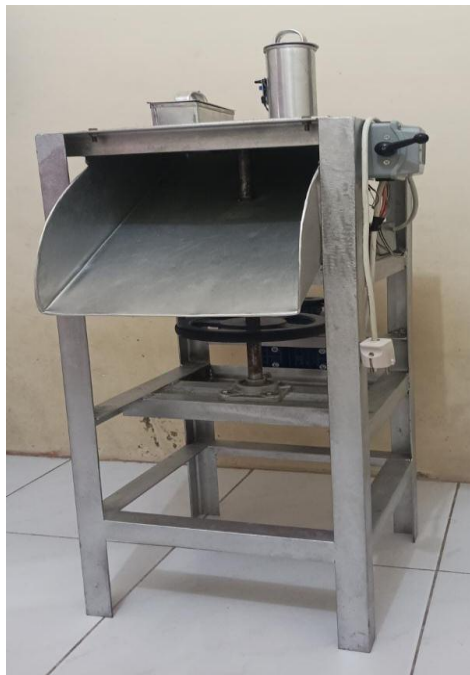
Gambar 4.13. Hasil Pembuatan Mesin Perajang Singkong dan Pisang
