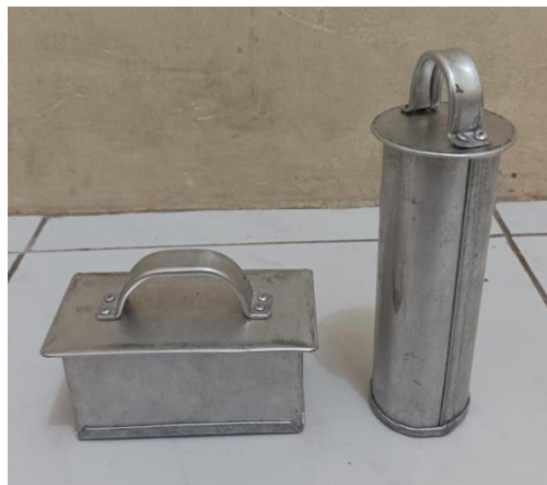
Gambar 4.11. Hasil Pembuatan Pendorong Singkong dan Pisang
