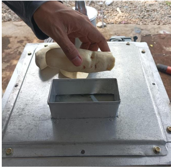
Gambar 4.16. Proses Memasukkan Singkong ke Corong Persegi Panjang
