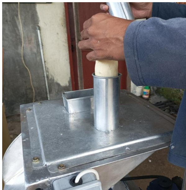
Gambar 4.15. Proses Memasukkan Singkong ke Corong Tabung
