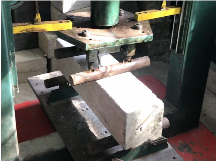
Gambar L.11: Pengujian kuat geser balok beton
