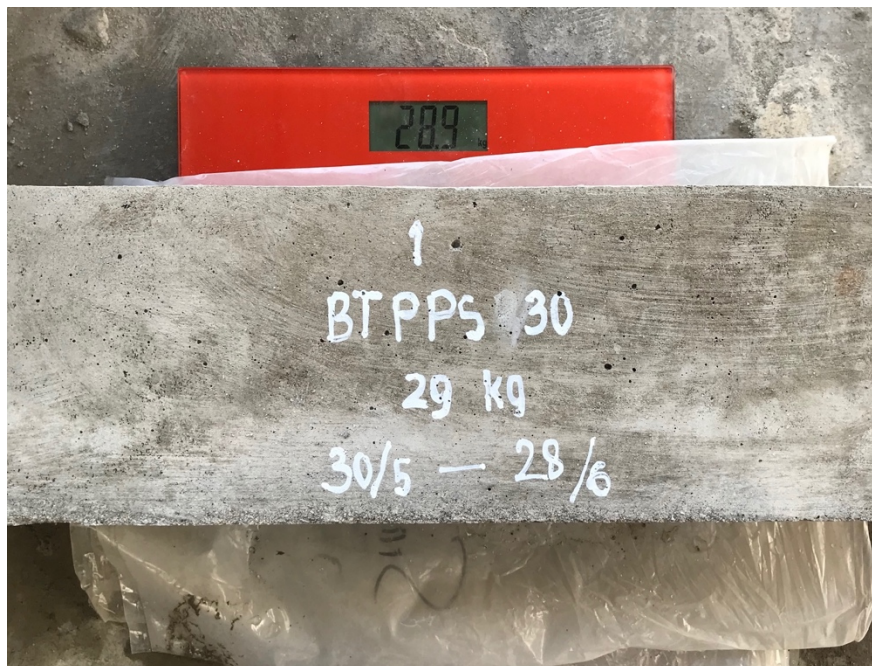
Gambar L.10: Benda uji balok ditimbang sebelum diuji
