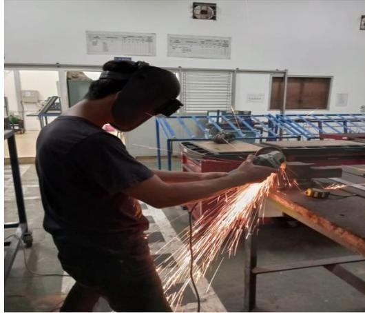
Gambar 4.22 Proses Pemotongan Plat *Flat*
