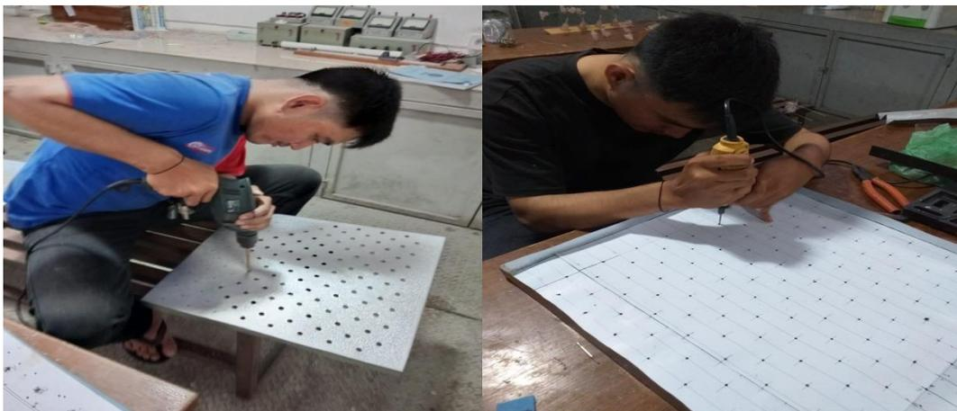
Gambar 2.17 Proses Pelubangan Plat *Filler*
