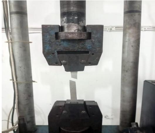
Gambar 4.32 Spesimen Percobaan Uji Tarik
