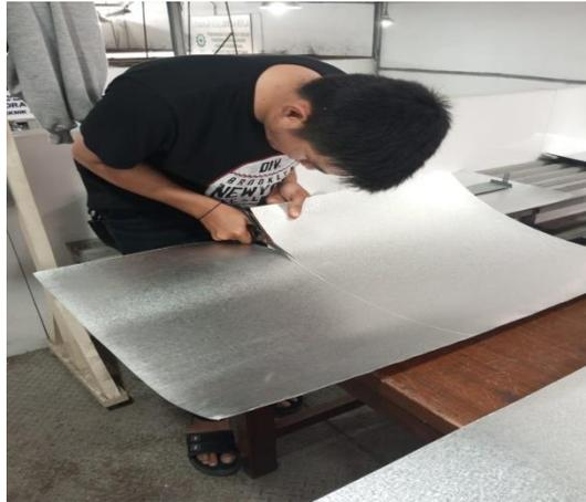
Gambar 2.16 Proses Pemotongan Plat *Filler*
