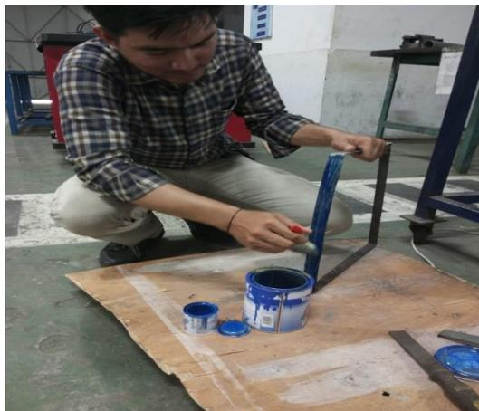
Gambar 4.27 Pengecatan Bingkai *Fill*
