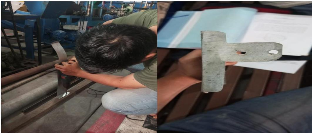
Gambar 4.31 Proses Pelubangan Penyangga Aliran Air
