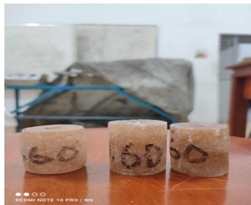
Gambar 4. 13 Bentuk Spesimen hadil dari pengujian tekan 0,60 gram Serat duria :
