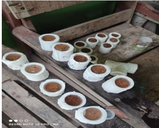
Gambar 4. 6 Proses Penuangan Spesimen
