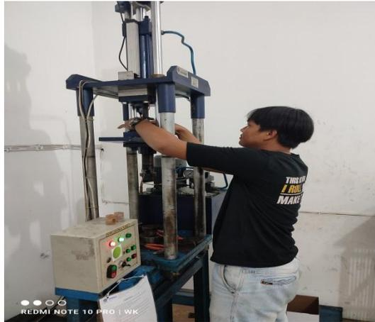
Gambar 4. 8 Meletakkan Spesimen di atas anvil
