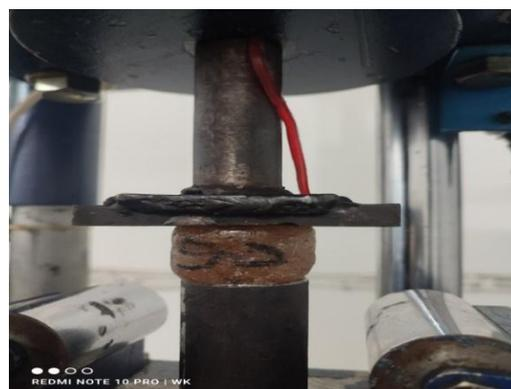
Gambar 4. 14 Bentuk Spesimen hadil dari pengujian tekan 0,90 gram Serat duria :
