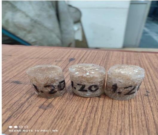
Gambar 4. 15 Bentuk Spesimen hadil dari pengujian tekan 1.20 gram Serat duria : 50 gram resin
