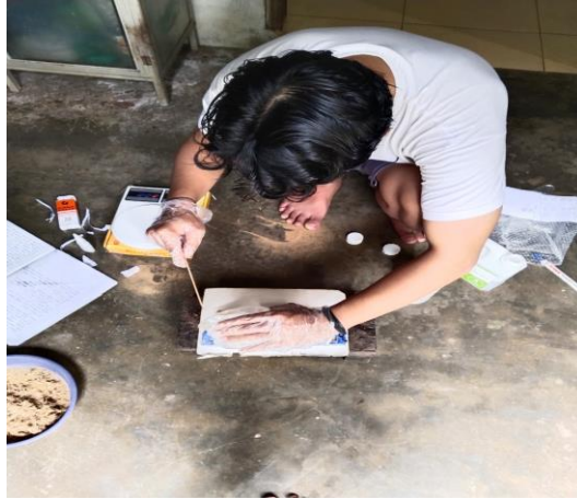
Gambar 4. 9 menuangkan resin dan katalis kedalam cetakan
