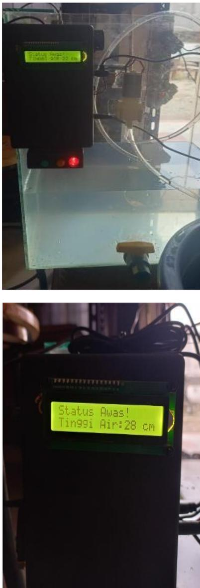
Gambar 4.11. Status Banjir Waspada, Ketinggian Air pada LCD dan Indikator Lampu Merah
