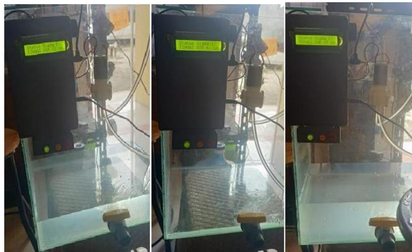
Gambar 4.8. Status Banjir Siaga 1, Ketinggian Air pada LCD dan Indikator Lampu Hijau
