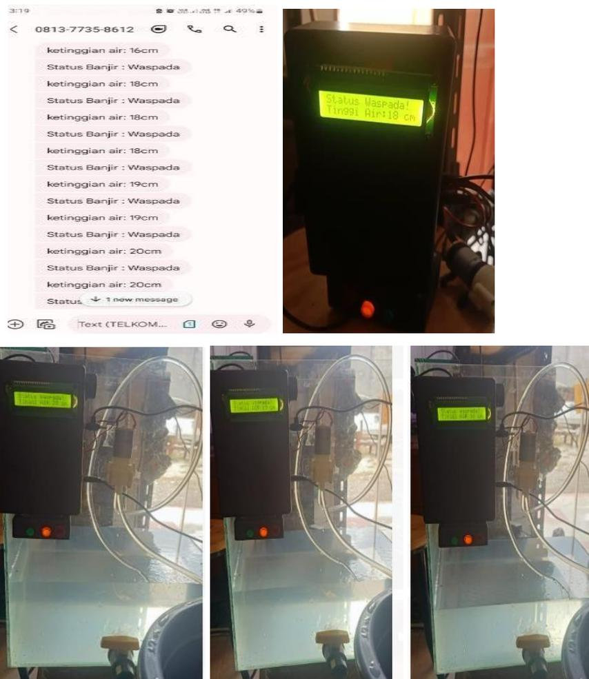
Gambar 4.9. SMS Notifikasi Status Waspada, Ketinggian Banjir dan Indikasi pada Alat
