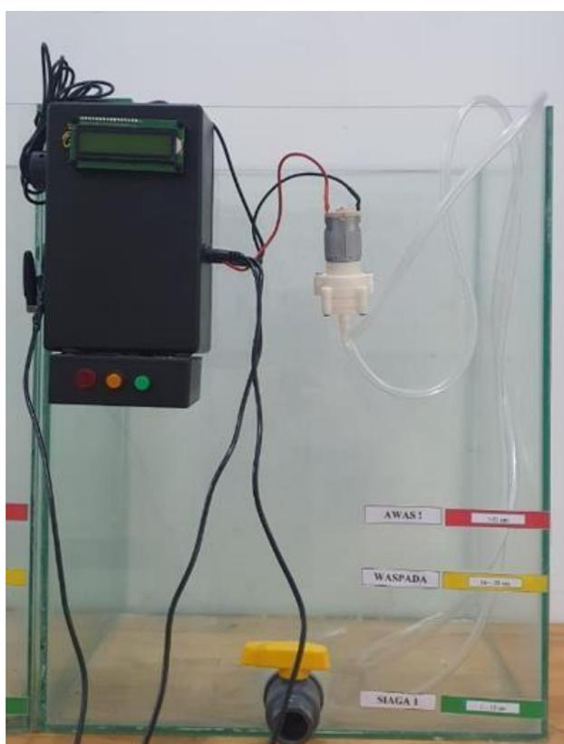
Gambar 3.3. Alat Monitoring Banjir Secara Keseluruhan
