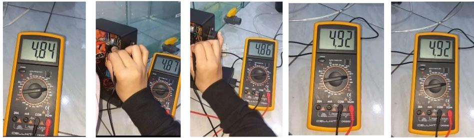
Gambar 4.4 Pengujian Tegangan Pada Sensor Ultrasonik
