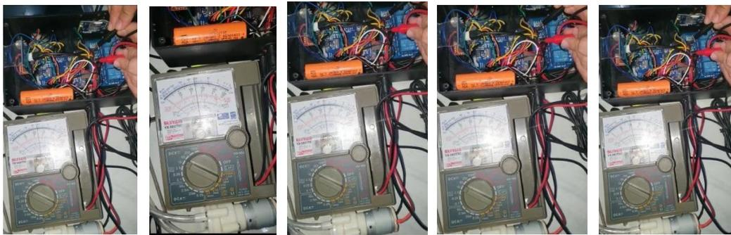
Gambar 4.7 Pengujian Tegangan Pada Relay
