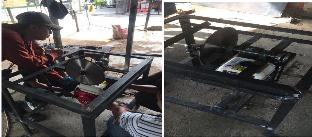
Gambar 4. 7 Pemasangan Mata Pisau dan Mesin
