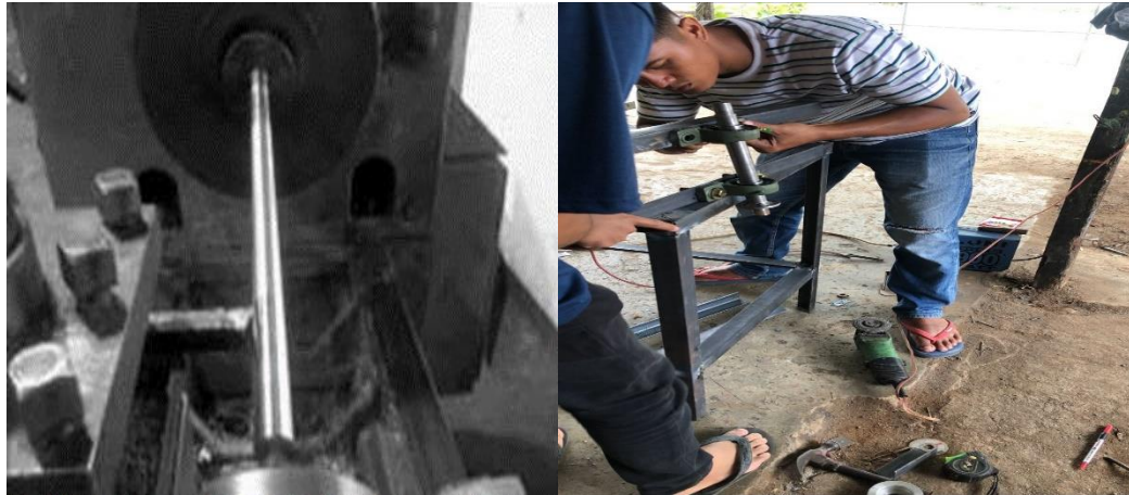
Gambar 4. 5 Pembuatan Poros dan Pemasangan Poros
