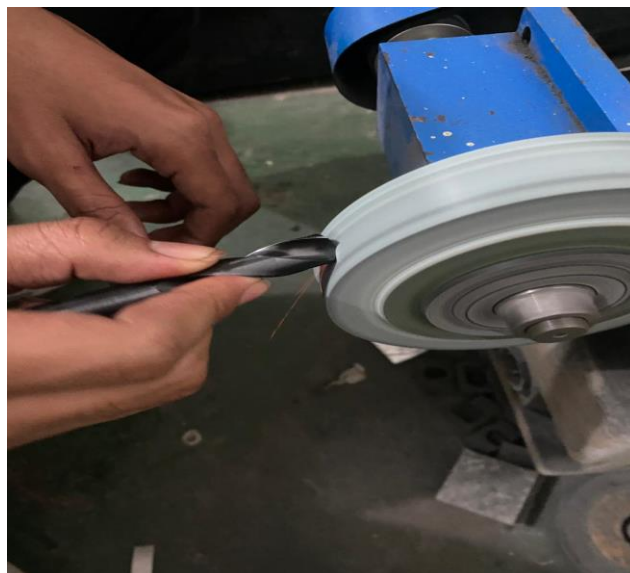
Mengasah sudut twist drill
