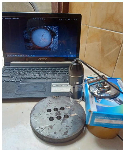
Gambar 4.7 Proses uji kebulatan
