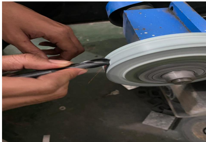
Gambar 4.3 Proses mengasah sudut twist drill
