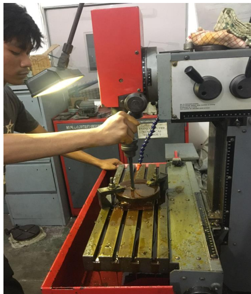
Gambar 4.5 Melakukan pengeboran pada spesimen
