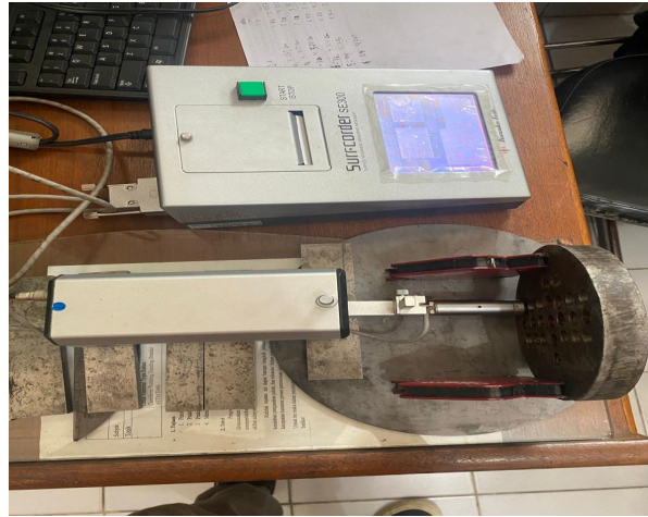
Gambar 4.6 Proses pengukuran kekasaran
