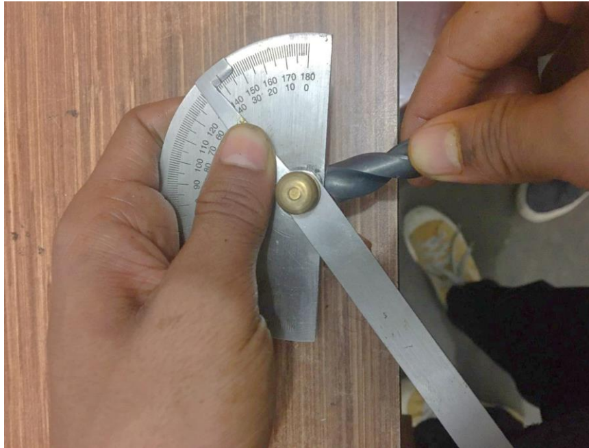
Mengukur sudut twist drill
