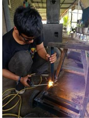
Gambar 4.9 Proses pengelasan pada rangka (V)
