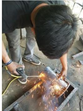
Gambar 4.17 Pengelasan sisi atas wadah briket
