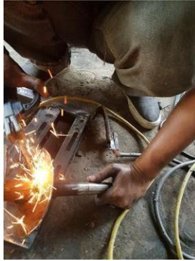
Gambar 4.14 Pengelasan poros dengan besi spiral (I)
