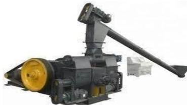
Gambar 2.5 Mesin Pencetak Tipe Stamping
