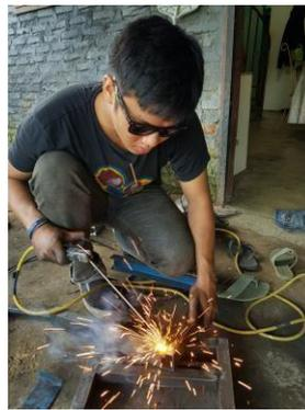
Gambar 4.6 Proses pengelasan pada rangka (II)
