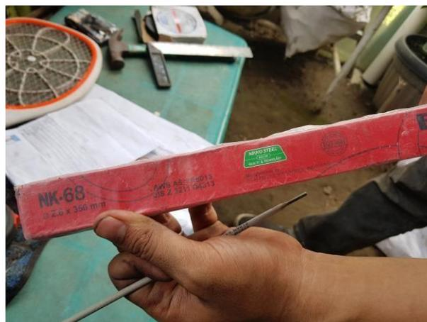
Gambar 4.4 Elektroda NK-68
