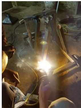
Gambar 4.10 Proses pengelasan pada rangka (VI)
