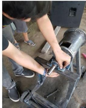
Gambar 4.24 Memasang bearing pada rangka
