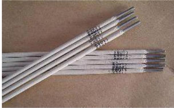
Gambar 3.16 Kawat Las atau Elektroda
