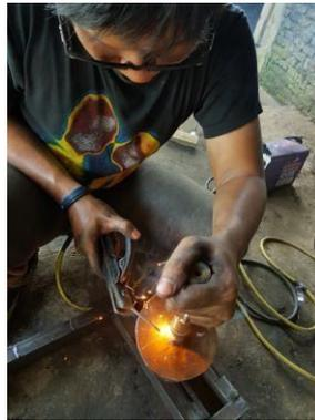
Gambar 4.15 Pengelasan poros dengan besi spiral (II)
