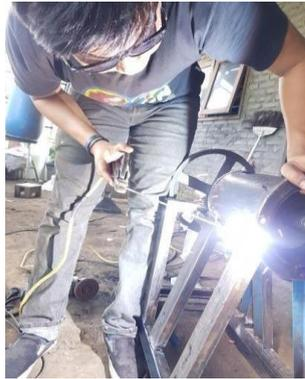
Gambar 4.27 Merapikan pengelasan pada wadah dan rangka
