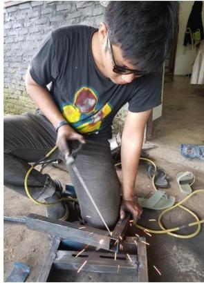
Gambar 4.5 Proses pengelasan pada rangka (I)
