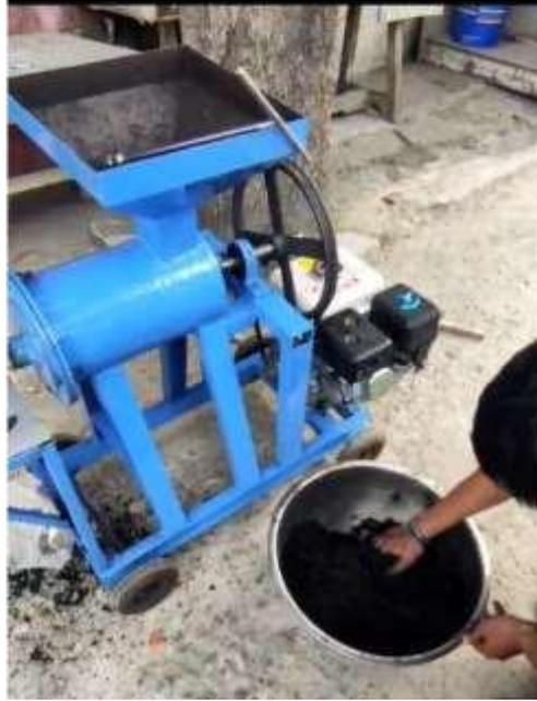
Gambar 4.9 Proses pencetakan briket (I)
