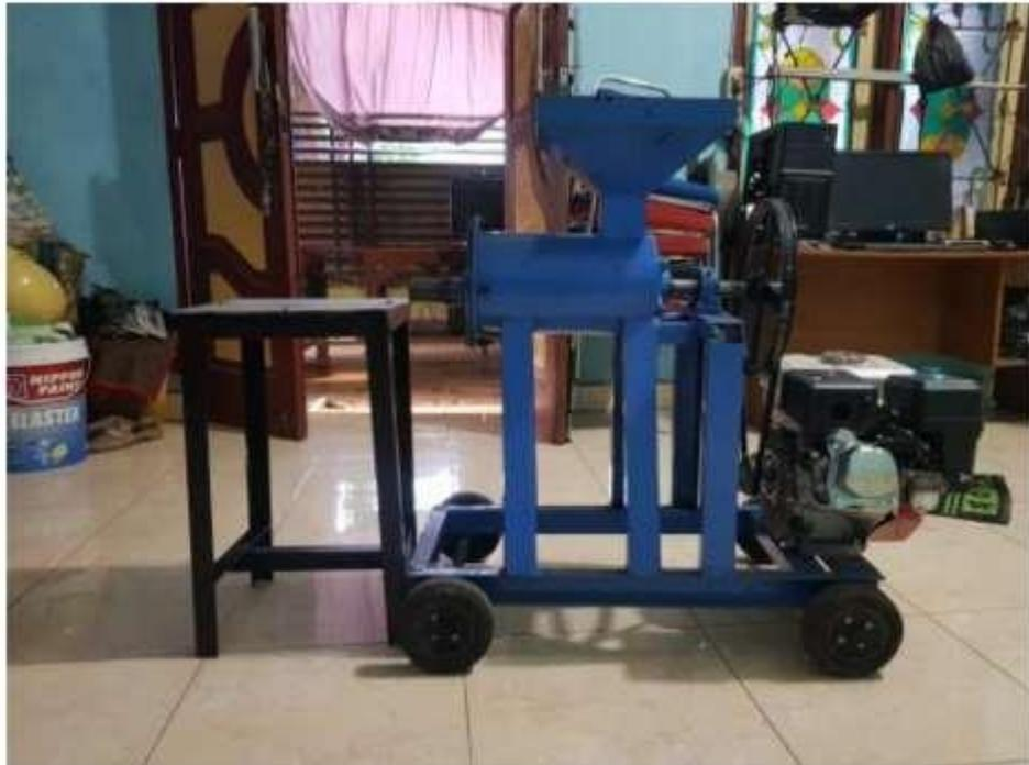
Gambar 3.7 Mesin Pencetak Briket Bonggol Jagung
