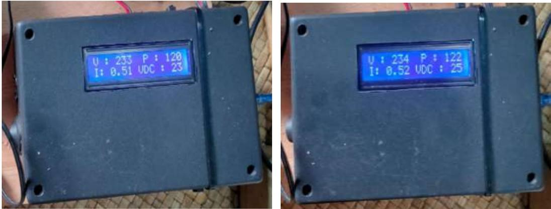
Gambar 4.3 Tampilan Data Pengisian Baterai 24 Volt Pada LCD
