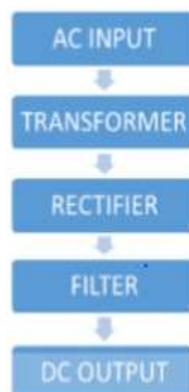
Gambar 2.9 Diagram Block Penyearah Gelombang
