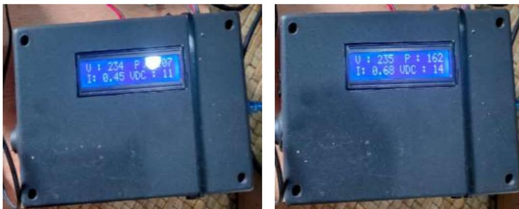
Gambar 4.2 Tampilan Data Pengisian Baterai 12 Volt Pada LCD
