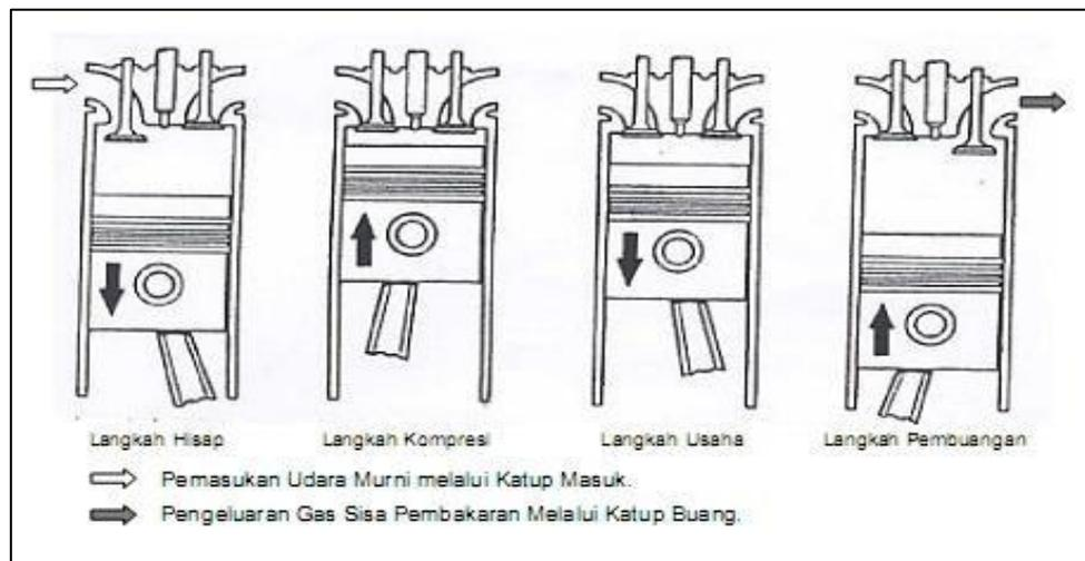
Gambar 2. 6 Prinsip Kerja Mesin Diesel
