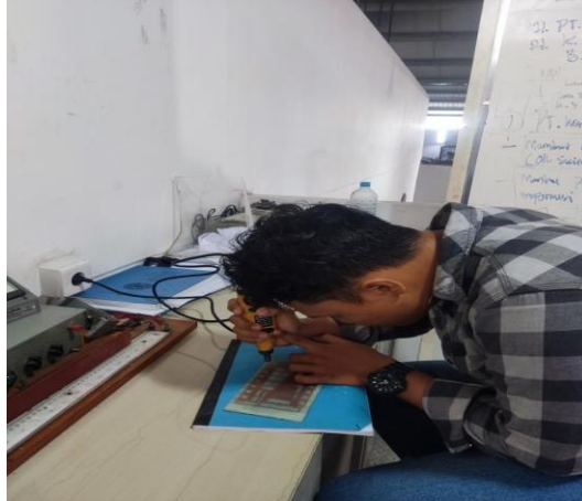
Gambar 4. 8 Melubangi Papan PCB
