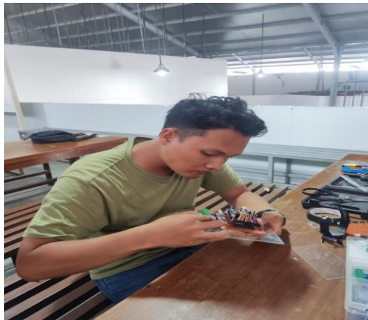
Gambar 4. 16 Pemasangan Rangkaian Sensor Ke Rumah Dudukan Sensor
