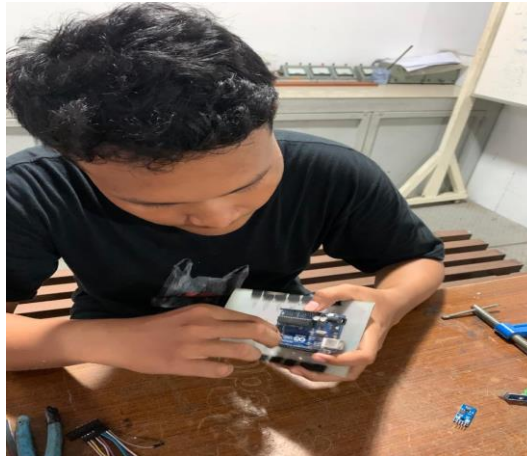
Gambar 4. 10 Pemasangan Arduino Ke Papan PCB
