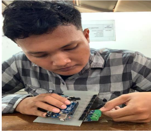
Gambar 4. 12 Pemasangan Modul MAX6675
