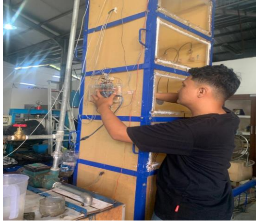
Gambar 4. 17 Pemasangan Rangkaian Sensor Ke Cooling Tower
