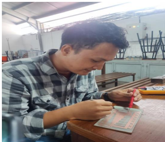
Gambar 4. 7 Pengecekan Layout Menggunakan Multi Tester
