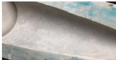
Gambar 4. 5 pengolesan dengan mirror glaze dan PVA
