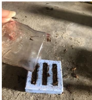
Gambar 3. 27 menuangkan campuran polister resin dan katalis ke dalam cetakan yang berisi serat
