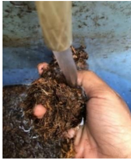
Gambar 4. 3 membilas serat kulit durian dngan air bersih
