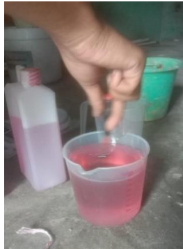
Gambar 3. 26 Proses Mencampur Resin Dan Katalis
