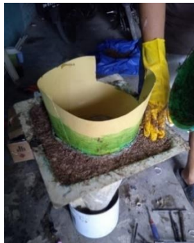
Gambar 4. 9 Proses Pengecoran Krucut Lalu lintas
