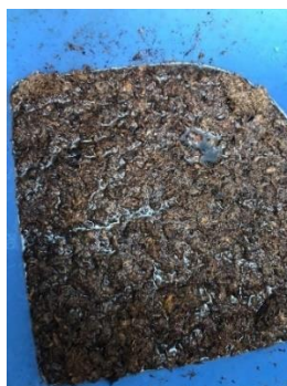
Gambar 4. 2 Merendam Serat kulit durian dengan cairan NaOH
