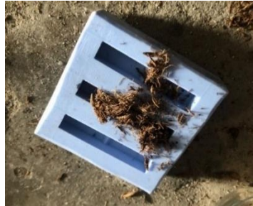
Gambar 3. 25 Meletakkan serat yang sudah di timbang
