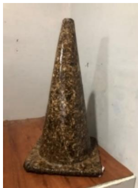
Gambar 4. 11 Hasil dari pembuatan kerucut lalu lintas menggunakan serat kulit durian
