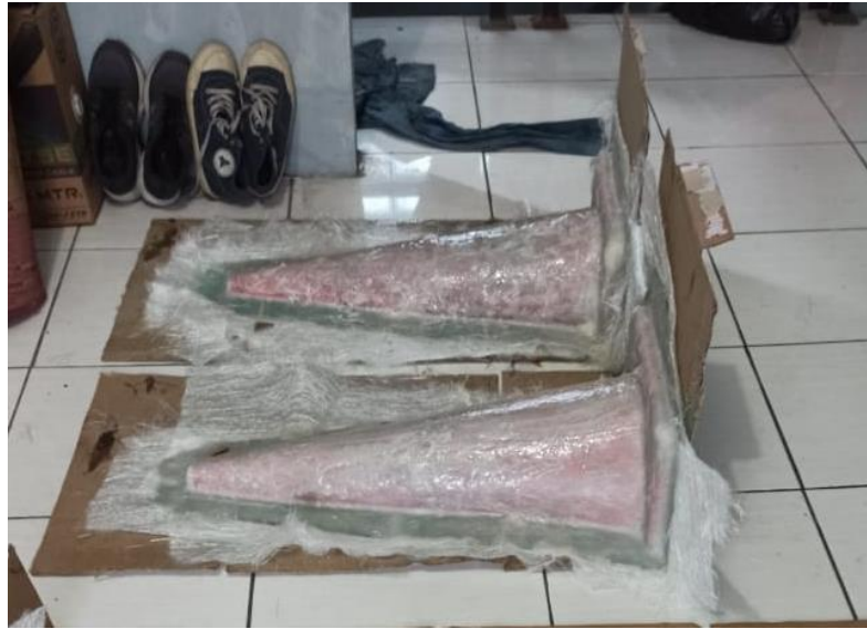
Foto pembuatan molding kerucut lalu lintas menggunakan fiber glass
