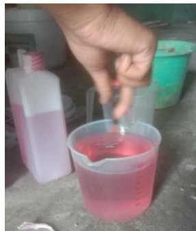
Gambar 4. 7 Mencampurkan Resin Dengan Katalis
