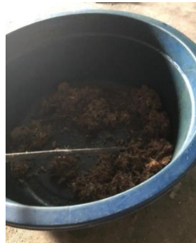
Gambar 4. 8 Pencampuran bahan Polyester resin, katalis dan serat kulit durian
