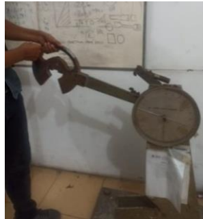
Gambar 3. 29 proses pengujian impak charpy
