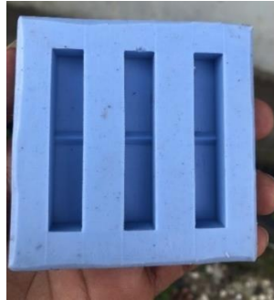
Gambar 3. 3 Cetakan specimen uji impact menggunakan rubber
