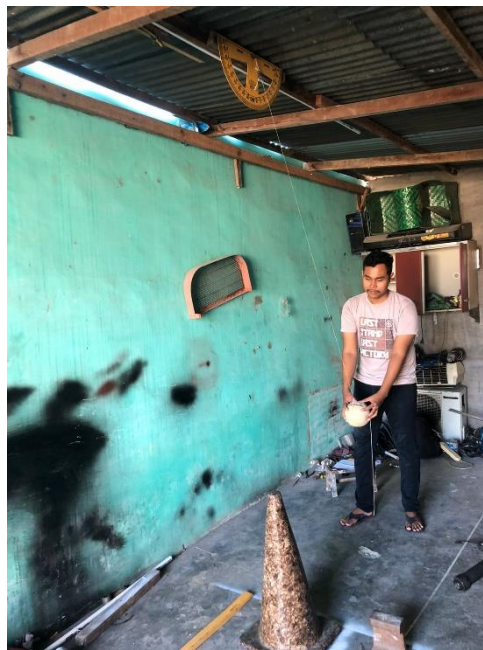
Foto pengujian stabilitas kerucut lalu lintas di perkuat Dengan kulit durian
