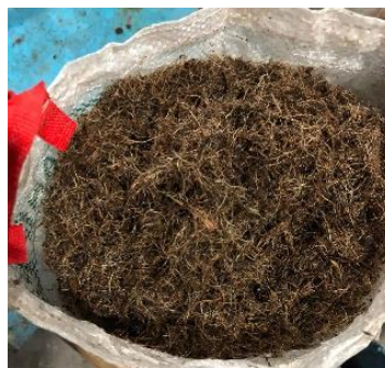
Gambar 3. 19 serat kulit durian yang sudah di cincang
