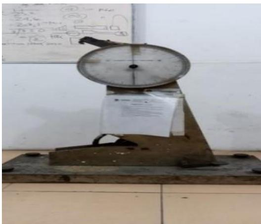
Gambar 3. 3 Alat uji impak
