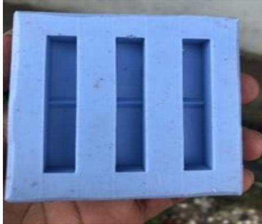
Gambar 3. 4 Cetakan spesimen uji impact
