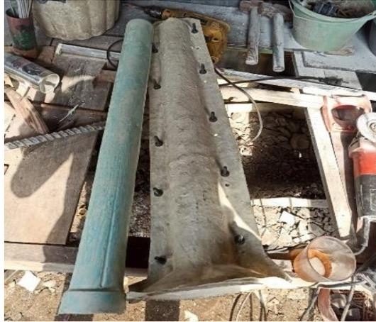
Gambar 4. 6 Proses pembukaan cetakan.
