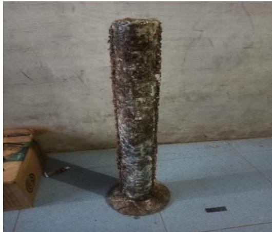
Gambar 4. 7 *Cone stick* setelah dibuka dari cetakan
