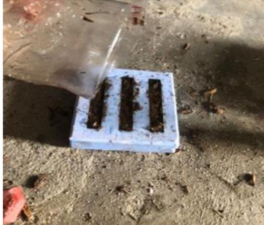
Gambar 4. 10 Proses penuangan resin
