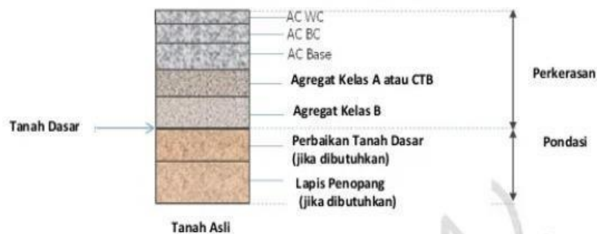
Gambar 2.2: Struktur perkerasan lentur (Kementrian pekerjaan umum danperumahan rakyat; direktorat Jendral Binam Marga, 2017).
