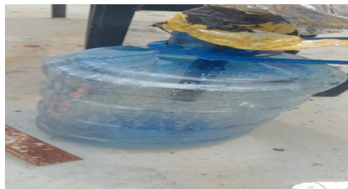
Gambar 3.5 Tangki Penampung Air Tawar Hasil Desalinasi
