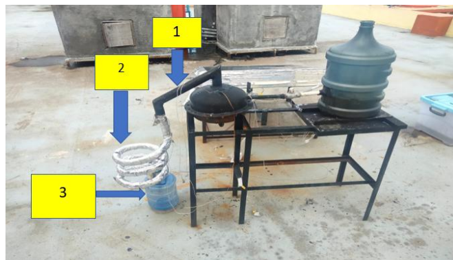
Gambar 4.2 Hasil perancangan dan pembuatan pipa spiral
