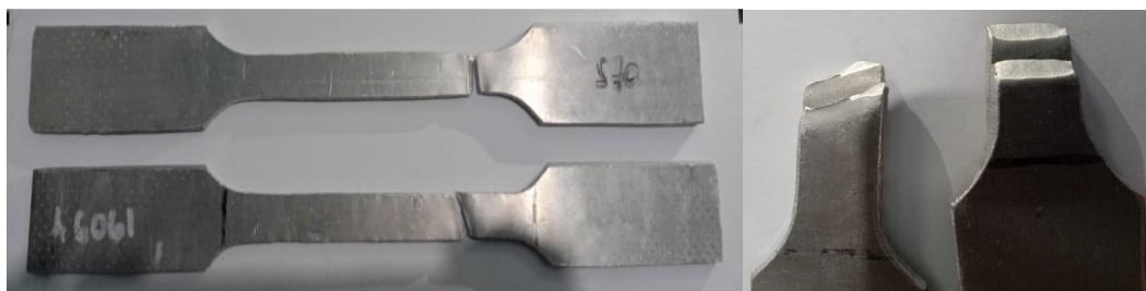
Gambar 4.4 Pengamatan Visual Patahan Uji Tarik RAW Material
