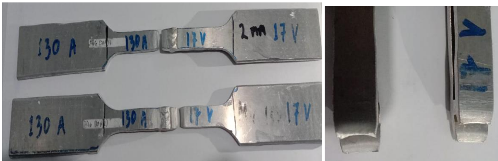
Gambar 4.6 Pengamatan Visual Patahan Spesimen Uji Tarik Arus 130 Amp
