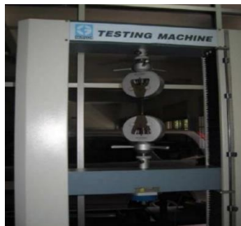
Gambar 3.5 Mesin Uji Tarik (Ludi Hartanto, 2009)
