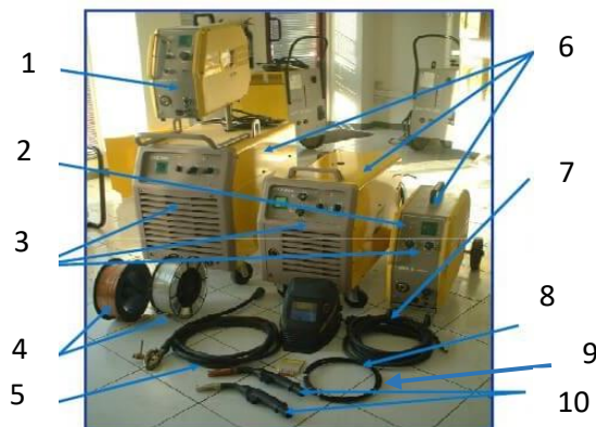
Gambar 2.3 Komponen Utama Pengelasan GMAW (Acmadi,2020)
