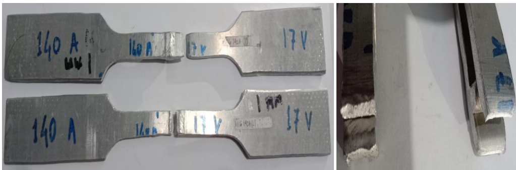
Gambar 4.7 Pengamatan Visual Patahan Spesimen Uji Tarik Arus 140 Amp
