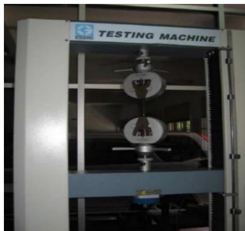
Gambar 2.19 Mesin Uji Tarik (Ludi Hartanto, 2009)
