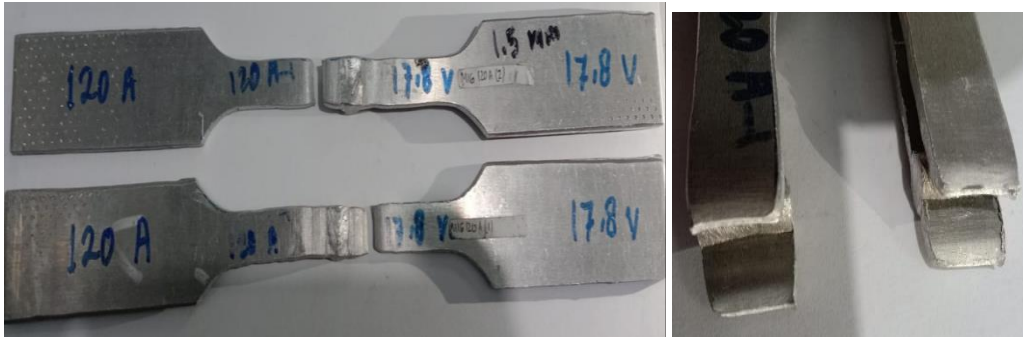
Gambar 4.5 Pengamatan Visual Patahan Spesimen Uji Tarik Arus 120 Amp
