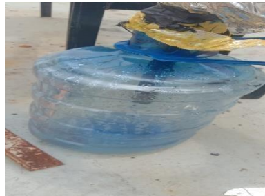
Gambar 3.7 Tangki Penampung Air Tawar Hasil Desalinasi
