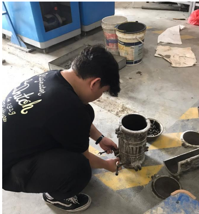
Gambar L. 12 : Pemasangan Bekisting Silinder
