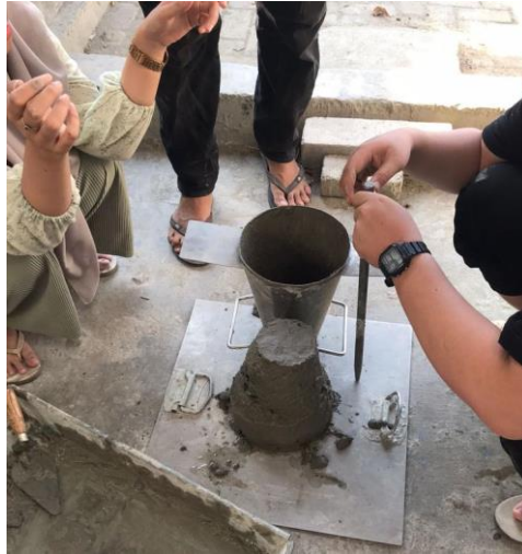
Gambar 3.3 : Pemeriksaan Slump test
