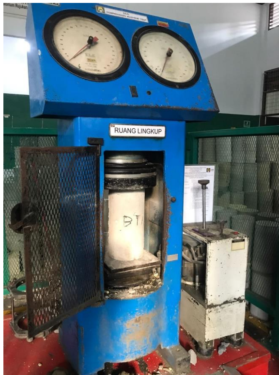
Gambar L. 19 : Pengujian Kuat Tekan Beton
