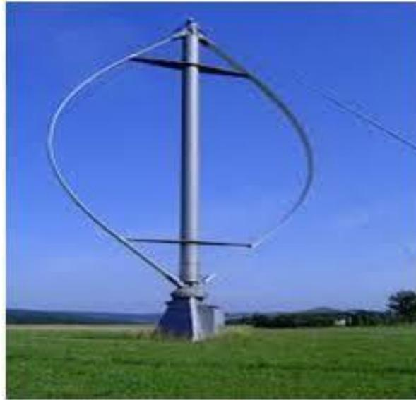
Gambar 2.2 Turbin Angin Sumbu Vertikal
