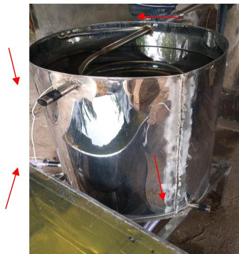
Gambar 3. 13 Pemasangan 4 titik thermocouple
