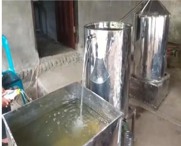
Gambar 4. 1 Alat penyulingan daun nilam skala *home industry*
