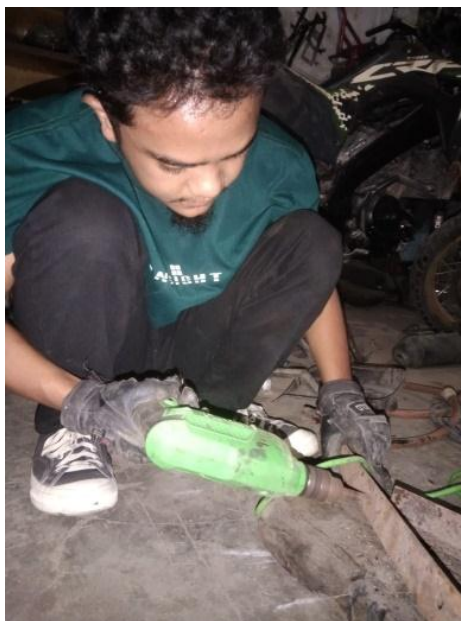
Gambar 4.11 Pemboran dudukan sambungan motor penggerak
