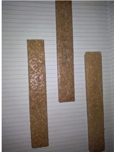
Gambar 4.16 Spesimen 4 Sebelum di Uji Lentur ( *Bending* )
