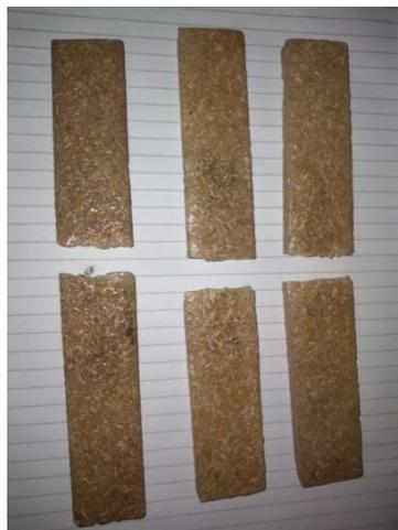
Gambar 4.11 Spesimen 1 Setelah di Uji Lentur ( *Bending* )
