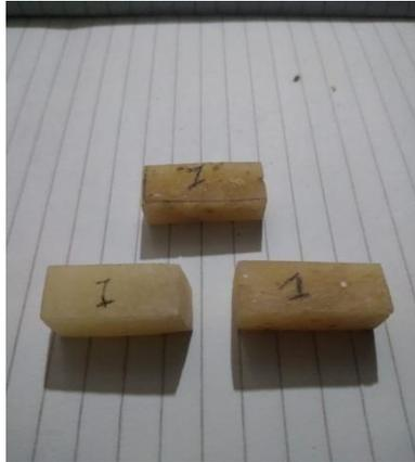
Gambar 4.2 Spesimen 1 Sebelum di Uji Tekan
