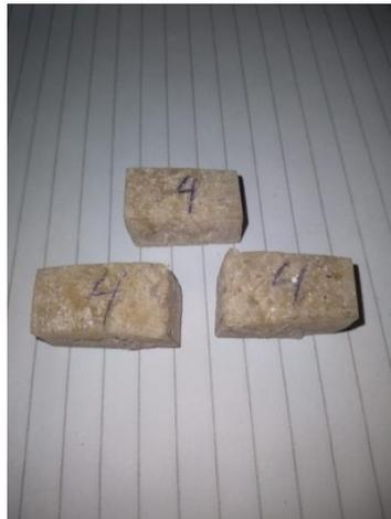
Gambar 4.9 Spesimen 4 Setelah di Uji Tekan
