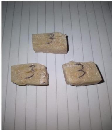
Gambar 4.7 Spesimen 3 Setelah di Uji Tekan
