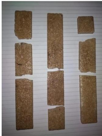
Gambar 4.15 Spesimen 3 Setelah di Uji Lentur ( *Bending* )
