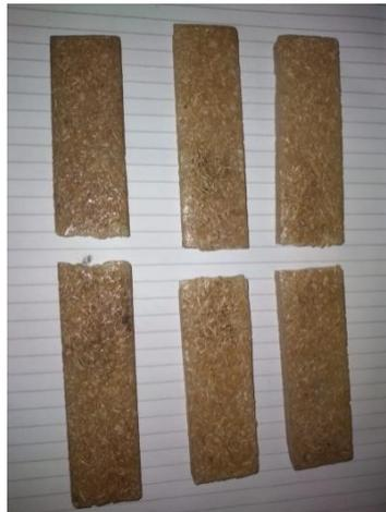
Gambar 4.17 Spesimen 4 Setelah di Uji Lentur ( *Bending* )
