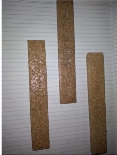
Gambar 4.12 Spesimen 2 Sebelum di Uji Lentur ( *Bending* )
