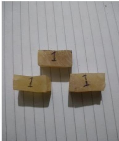
Gambar 4.3 Spesimen 1 Setelah di Uji Tekan
