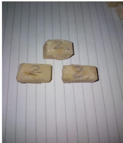
Gambar 4.5 Spesimen 2 Setelah di Uji Tekan
