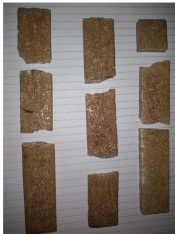
Gambar 4.13 Spesimen 2 Setelah di Uji Lentur ( *Bending* )
