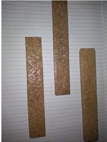
Gambar 4.14 Spesimen 3 Sebelum di Uji Lentur ( *Bending* )
