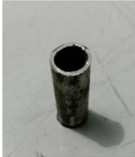
Gambar 3.3. Cetakan spesimen uji tekan (*compress*).
