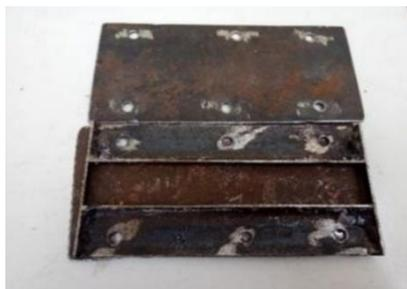
Gambar 3.4 Cetakan spesimen uji lentur (*Bending*)
