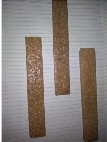
Gambar 4.10 Spesimen 1 Sebelum di Uji Lentur ( *Bending* )
