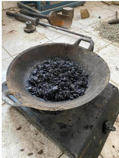
Gambar L.10: Proses Pencampuran Benda Uji
