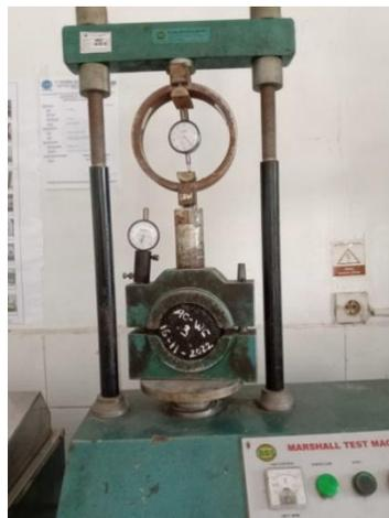
Gambar 2.2 Alat Pengujian Marshall (Laboratorium PT. Adhi Karya)
