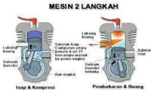
Gambar 2.2 Langkah Gerakan Torak 2 Langkah
