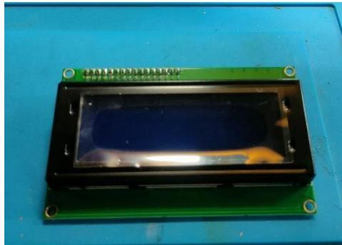
Gambar 3.6. LCD 20x4
