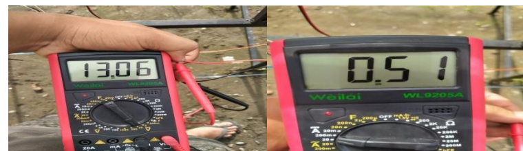
Gambar 4.15 Pengukuran Pada Pukul 09.00 Wib Pada Saat Pengujian Pengisian Baterai Menggunakan Panel Surya Tanggal 16 Juli 2023
