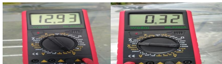
Gambar 4.14 Pengukuran Pada Pukul 08.00 Wib Pada Saat Pengujian Pengisian Baterai Menggunakan Panel Surya Tanggal 16 Juli 2023
