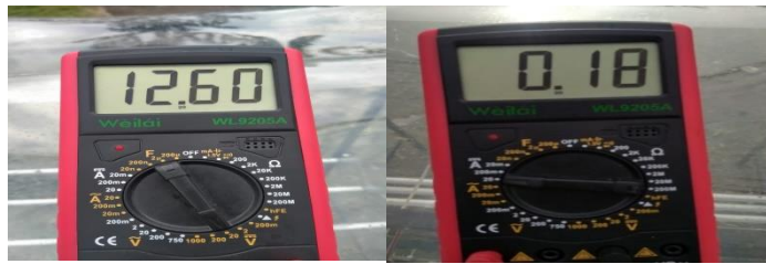
Gambar 4.11 Pengukuran Pada Pukul 08.00 Wib Pada Saat Pengujian Pengisian Baterai Menggunakan Panel Surya Tanggal 12 Juli 2023
