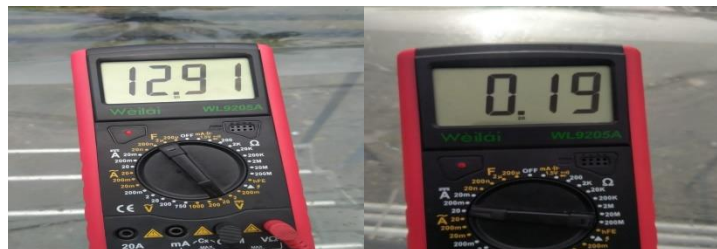
Gambar 4.12 Pengukuran Pada Pukul 09.00 Wib Pada Saat Pengujian Pengisian Baterai Menggunakan Panel Surya Tanggal 12 Juli 2023
