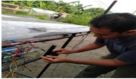
Gambar 3.31 Pemasangan Motor Servo ke Breket Dudukan Untuk Rangka Jemuran
