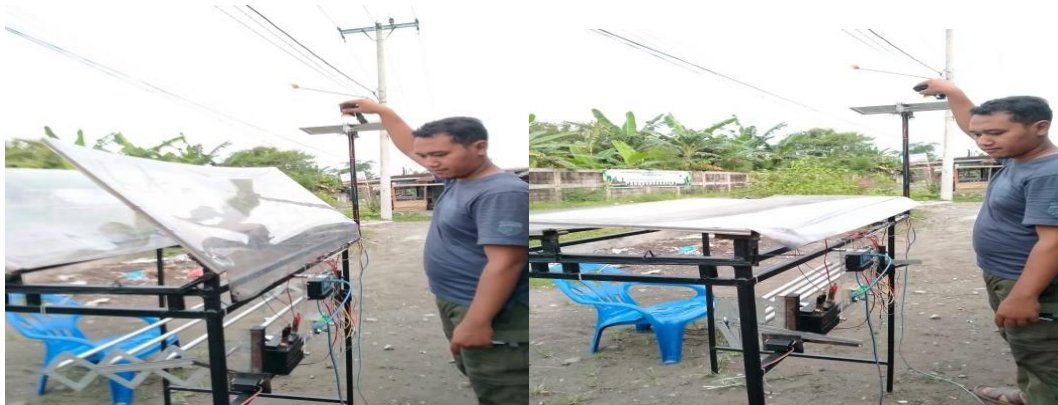
Gambar 4. Pengujian Menggerakkan Atap dan Rangka Jemuran
