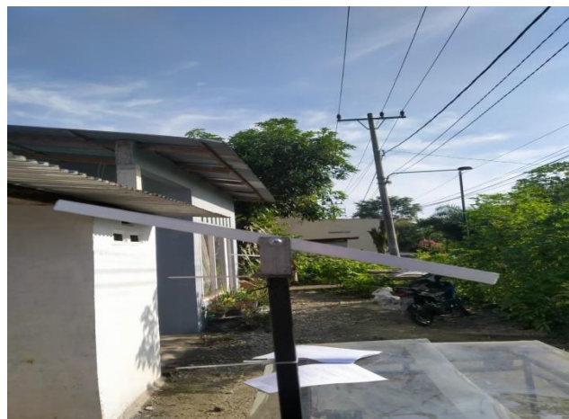
Gambar 6. Pengaturan Sudut Keniringan Pada Panel Surya
