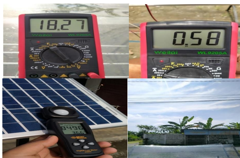
Gambar 4.8 Pengukuran Pada Pukul 09.00 Wib Pada Saat Pengujian Panel Surya Tanggal 30 Agustus 2023
