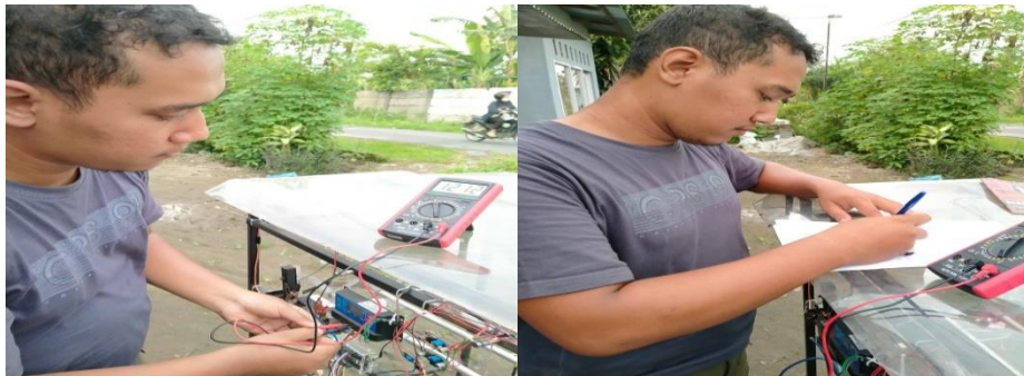
Gambar 3.35 Pengukuran Output Tegangan dan Arus Dari Panel Surya ke Pengisian Baterai Melalui Solar Charge Controller
