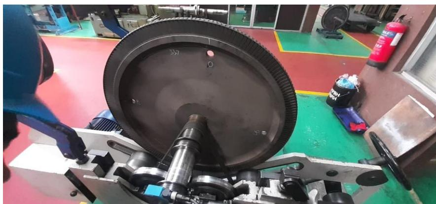
Gambar 4.12 Pemberian tanda pada *Rotor Wheel*
