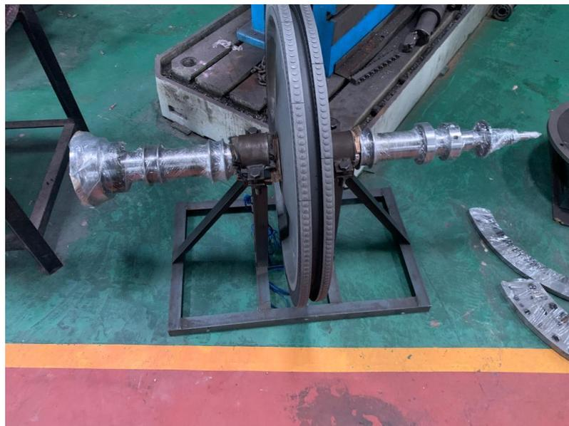
Gambar 4.28 Rotor Wheel Telah Selesai Di perbaiki.
