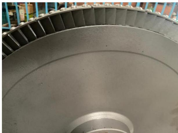
Gambar 4.11 Hasil *Wheel* Setelah Di Sandblast
