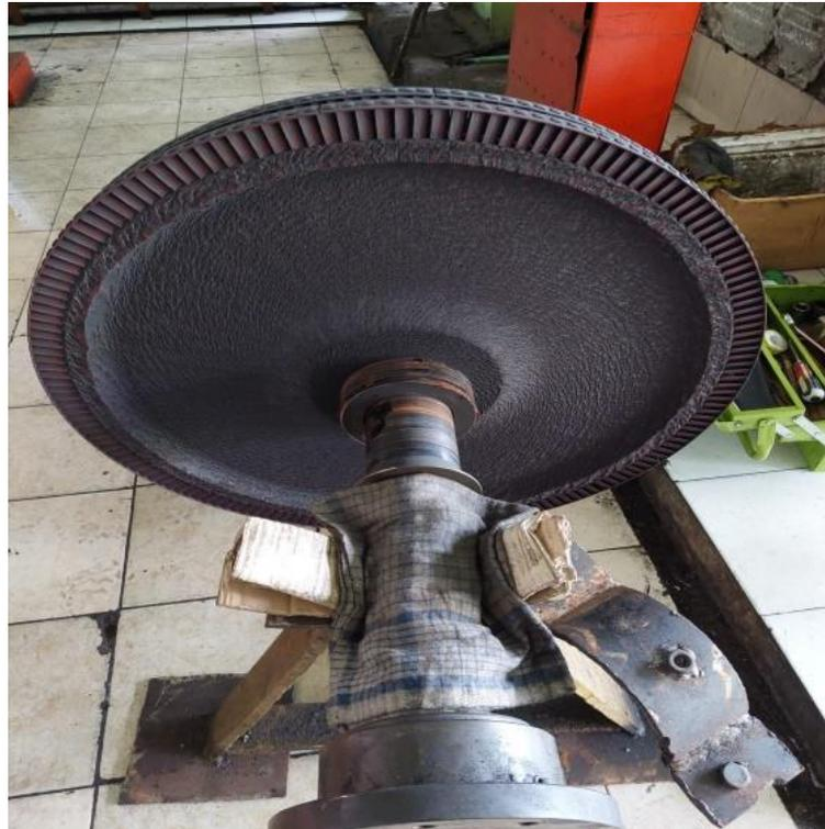
Gambar 3.2 Kerusakan Pada *Rotor Wheel*.
