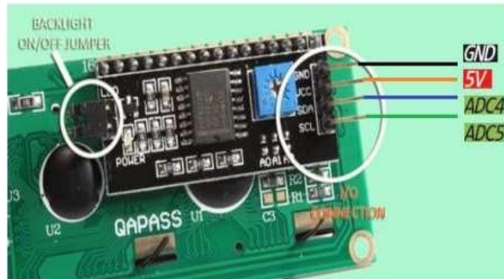
Gambar 2.13. Konfigurasi PIN LCD
