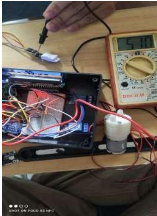
Gambar 4.9 Pengukuran Sensor DHT
