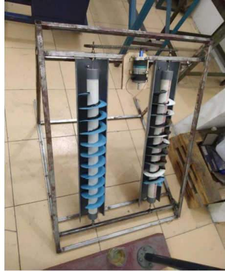
Gambar 4.18 Pemasangan Rantai Penghubung
