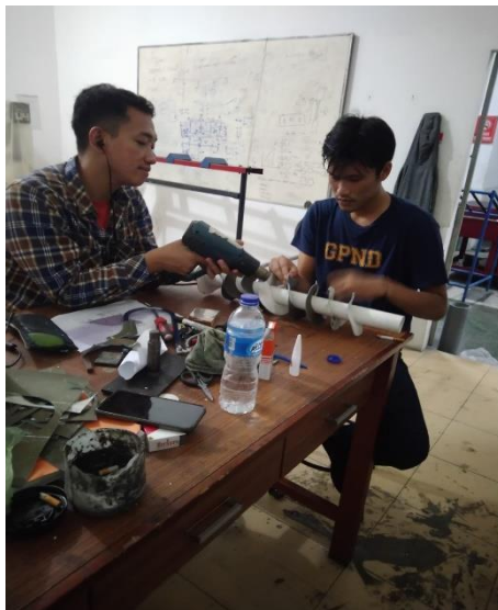
Gambar 4.11 Proses Pembentukan Bilah
