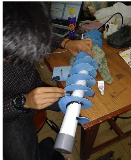
Gambar 4.12 Proses Penutupan Celah Bilah
