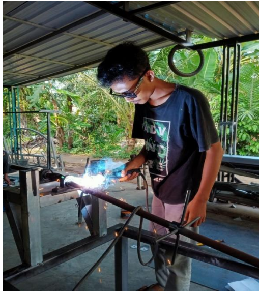
Gambar 4.10 Pengelasan jari jari rangka pada besi as
