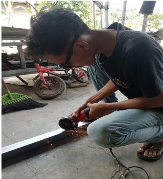
Gambar 4.2 Memotong besi hollow sesuai ukuran yang diperlukan
