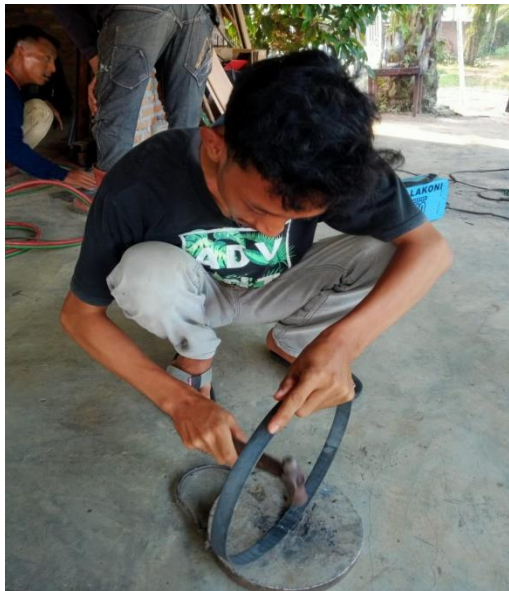
Gambar 4.11 Proses pembuatan rangka berbentuk lingkaran
