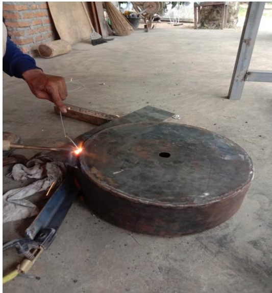
Gambar 4.18 Proses pembuatan hopper ketiga
