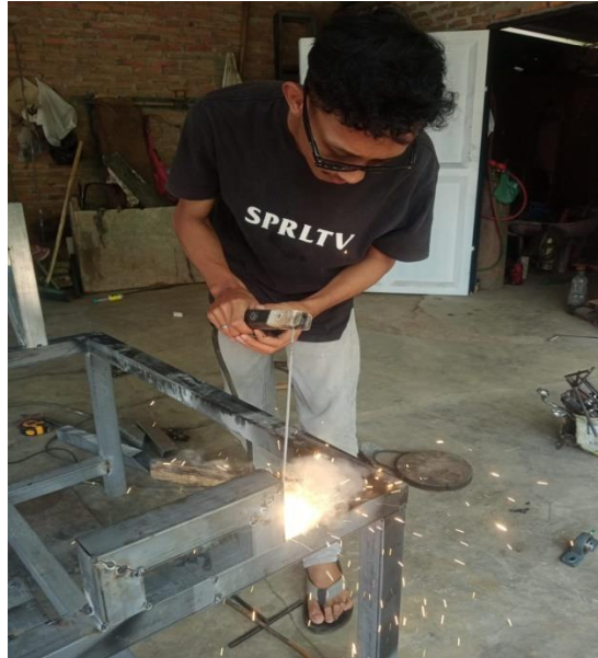
Gambar 4.4 Pengelasan bagian dudukan bearing
