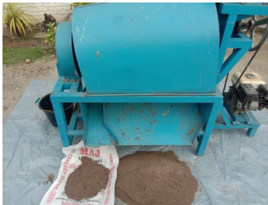
Gambar 4.37 proses pengayakan dengan alat ayakan 3 saringan ke 40 detik
