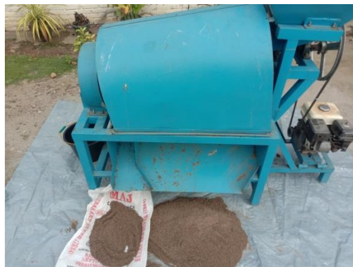
Gambar 4.34 proses pengayakan dengan alat ayakan 3 saringan ke 20 detik
