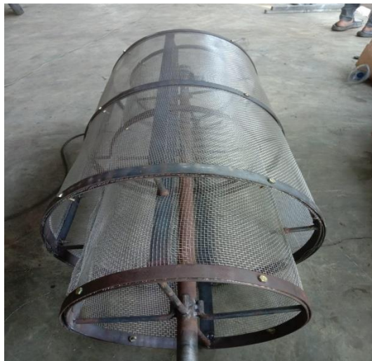
Gambar 4.16 Pemasangan kawat lapisan kedua
