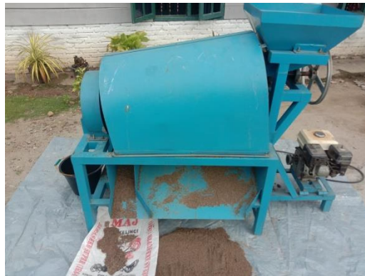
Gambar 4.40 proses pengayakan dengan alat ayakan 3 saringan ke 40 detik
