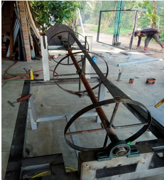
Gambar 4.12 Pengelasan rangka dan jari-jari
