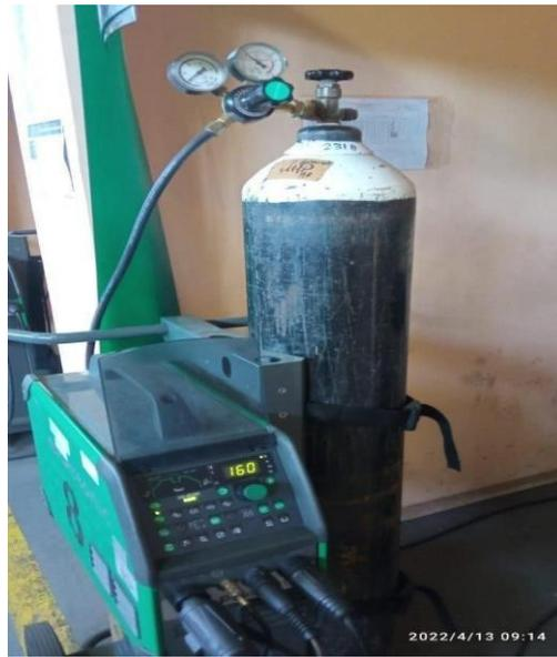
Gambar 3.1. Mesin las GTA
