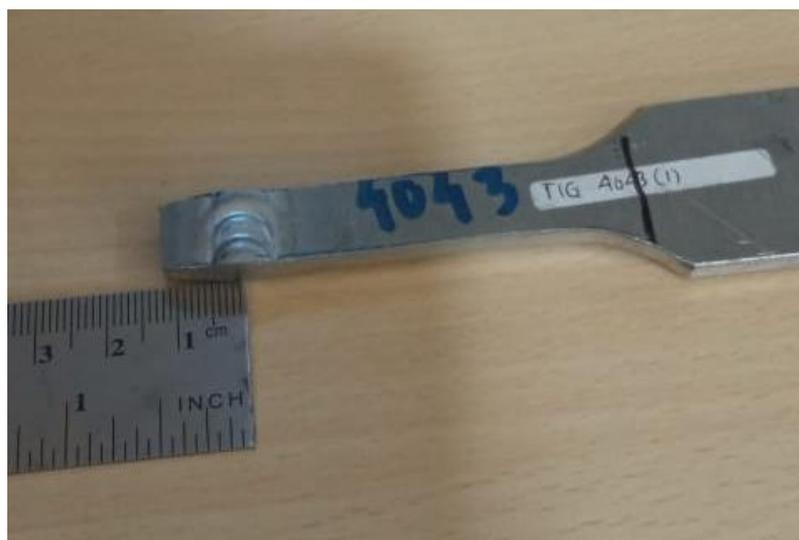
Gambar 4.2. Pengujian Tarik Spesimen 1
