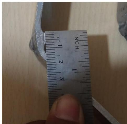
Gambar 4.7. Crack pada area *welded*
