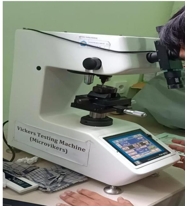
Gambar 3.9. Alat uji kekerasan
