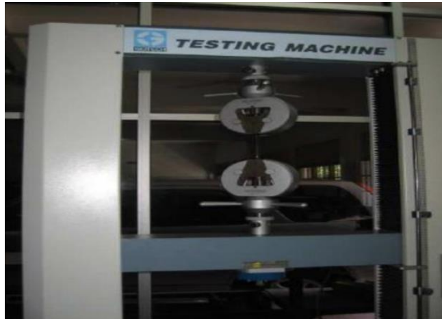
Gambar 2.20. Mesin uji Tarik (Ludi Hartanto, 2009)
