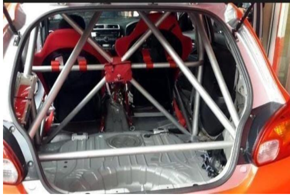
Gambar 2.19. Aluminium 6061 pada rangka pelindung (roll cage) pada mobil balap rally
