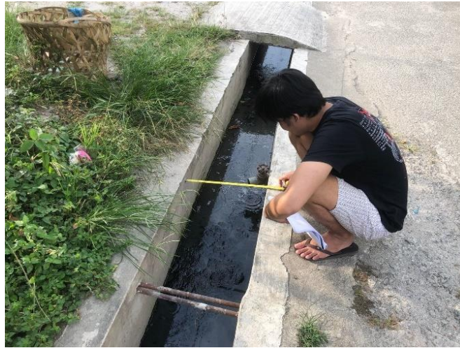
Gambar L-1: Mengukur lebar atas saluran drainase
