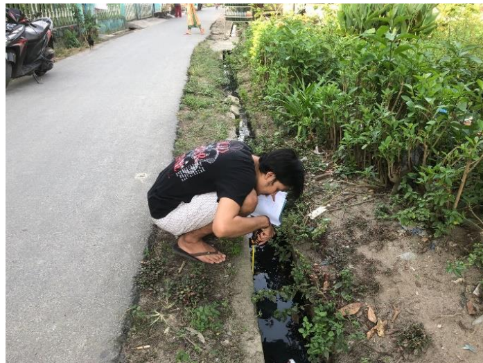
Gambar L-2: Mengukur kedalaman saluran drainase
