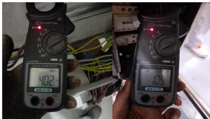
Gambar 4.1. Sebelum dan sesudah terjadinya lonjakan arus pada conveyor otomatis
