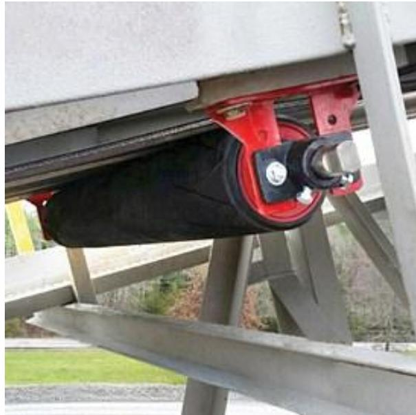
Gambar 2.10. *Idler Conveyor* Otomatis
