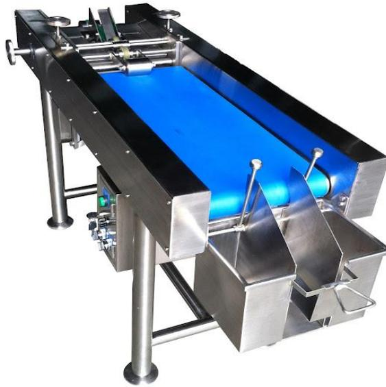
Gambar 2.15. *Feeder Conveyor* Otomatis
