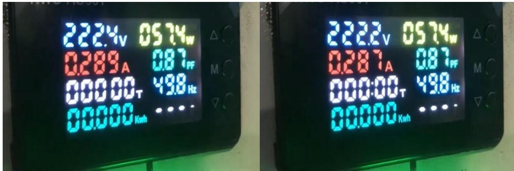
Gambar 4. 2. perbandingan arus yang sudah dipasang rangkaian star delta
