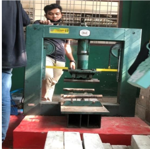
Gambar 4.2 Pengujian kuat lentur
