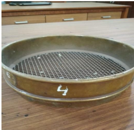
Gambar 3.2 Saringan agregat halus no.4
