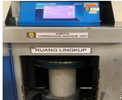
Gambar 4.1 pengujian kuat tekan
