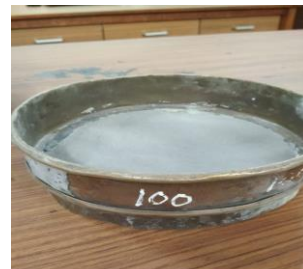
Gambar 3.3 Saringan no.50 dan Saringan no.100
