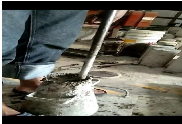
Lampiran 30 : Proses Perojokan Adukan Beton Di Cetakan.
