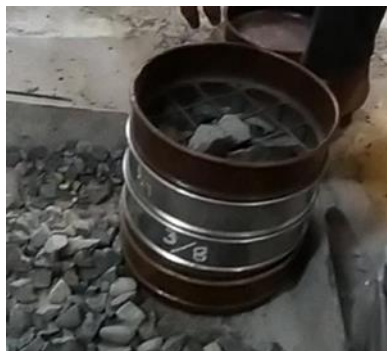
Lampiran 9 : Saringan Agregat Kasar.
