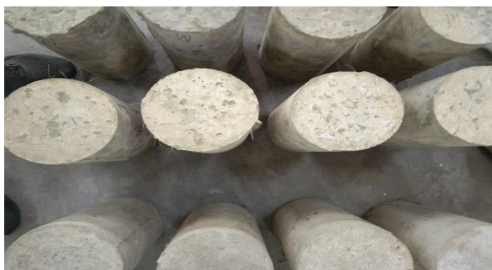
Lampiran 33 : Limbah konstruksi beton 5% dan Serat Sabut Kelapa 0,7%
