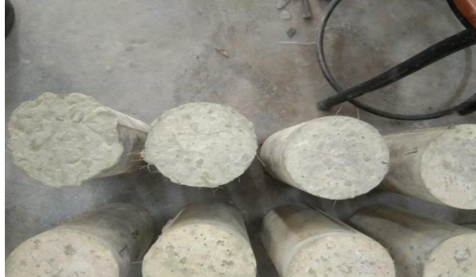
Lampiran 34 : Limbah kontruksi Beton 7% dan Serat Sabut Kelapa 0,7%
