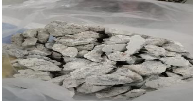
Gambar 3.8 : Limbah konstruksi beton
