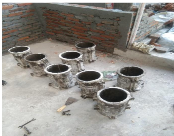
Lampiran 10 : Cetakan Silinder.
