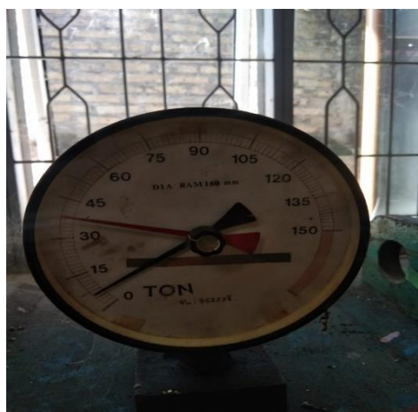
Lampiran 36 : Proses Pengujian Kuat tekan beton.
