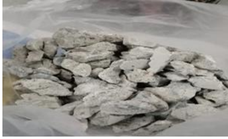
Lampiran 7 : Limbah kontruksi beton
