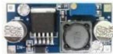
Gambar 2. 21 Modul IC Step Down LM2596
