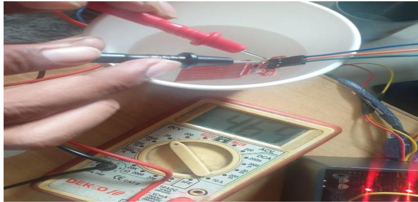
Dari gambar 4.12 Dalam menganalisis kinerja sensor adapun parameter data yang diambil adalah tegangan dan arus yang mengalir pada sensor pada saat bekerja, dimana tegangan dan arus diukur menggunakan alat ukur yaitu multimeter digital.
