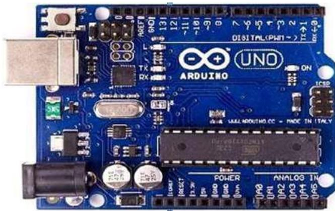
Gambar 2.20 Mikrokontroler Gambar Arduino Uno ATmega328
