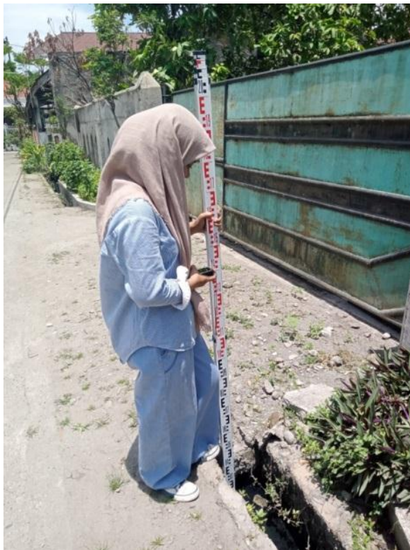
Lampiran 1. 10 Pengukuran menggunakan bak ukur
