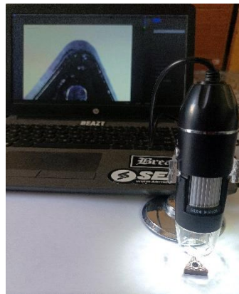
Gambar 4.2 Pengujian keausan pahat dengan mikroskop digital
