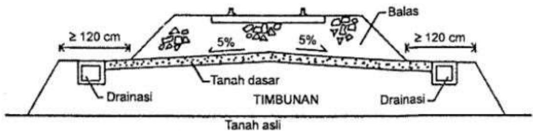
Gambar 2. 16 : Badan Jalan Rel Pada Timbunan
