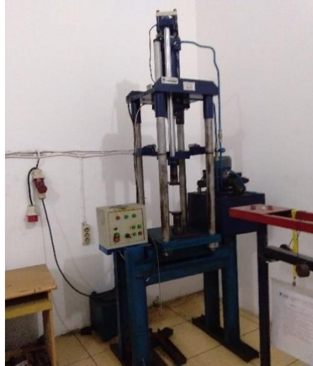
Gambar 4.12 Mesin Uji Tarik dan Kelengkapannya
