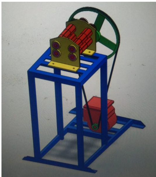
Gambar 3.18 Gambar Teknik Sederhana Mesin Tebu 4 Roller
