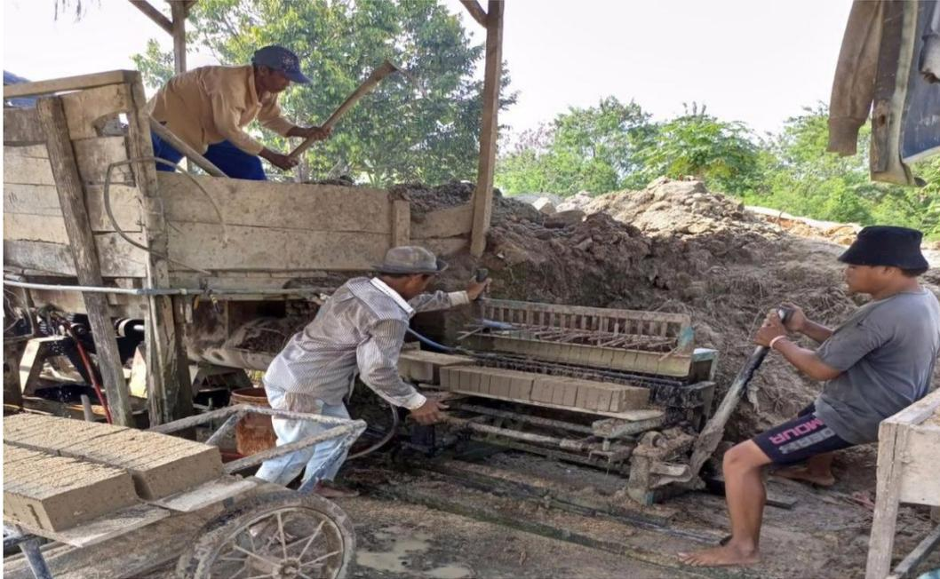
Gambar 2.1. Proses produksi batu bata
