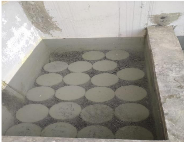
Gambar L-22: Perendaman benda uji silinder.
