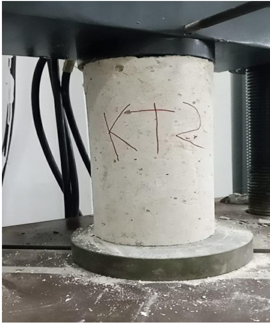
Gambar L-25: Proses pengujian Kuat tekan.
